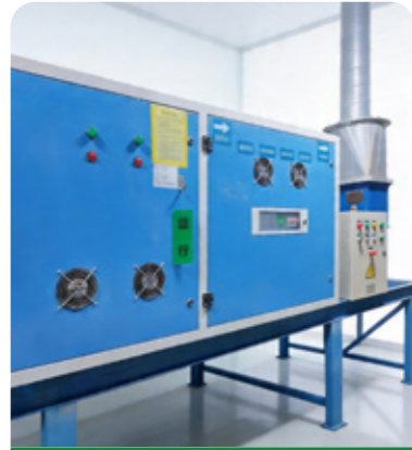
車間有機廢氣 處理設備
